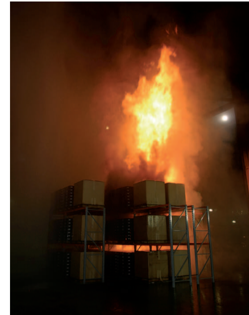
Ein Regallager-Brandtest auf dem Research Campus von FM Global gibt Aufschluss darüber, wie sich ein Feuer bei einer bestimmten Belegung verhält.
