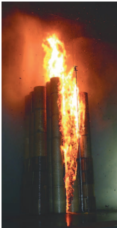
Brandversuch mit Papierrollen im FM Global Research Campus in Rhode Island/USA.
